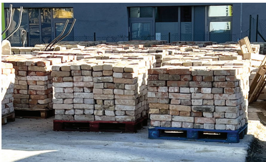
Obr. č. 1: Tehly z demolácie pripravené na opätovné použitie (Zdroj: Mgr. Zuzana Krajčovičová, Bratislava, 2023)
