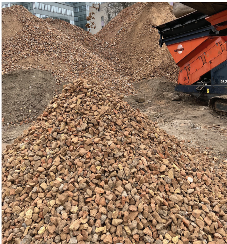
Obr. č. 3: Vhodne vytriedený recyklát, ktorý má malé uplatnenie na trhu (Zdroj: Mgr. Zuzana Krajčovičová, Bratislava, 2023)
